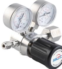
HC11型高压单级标准流量不锈钢减压阀，单级式金属膜片调压结构；适用于高纯气体、标准气体、一般腐蚀性气体。
